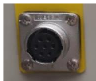
Порт подключения выносного термогигростата
