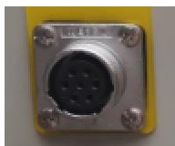
Порт подключения выносного термогигростата
